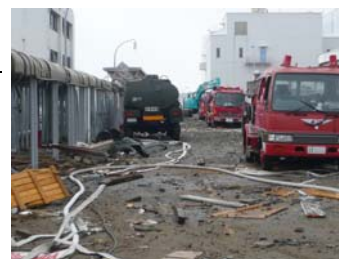
消防車による注水 (配置は後日のもの)
