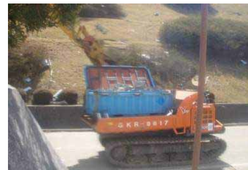
コンテナをクローラダンプで移動
