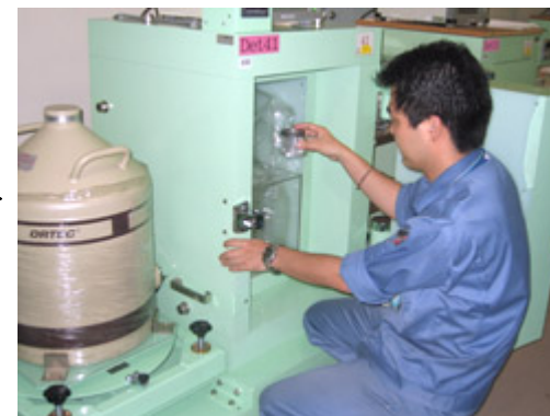
<ゲルマニウム半導体検出器※2> ろ紙に付着した放射性物質を分析
