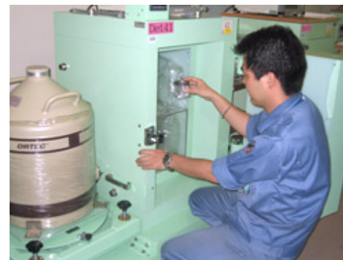
<ゲルマニウム半導体検出器※2> ろ紙に付着した放射性物質を分析
