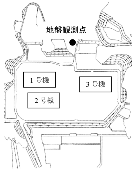
図-2 敷地地盤の地震計設置位置図
