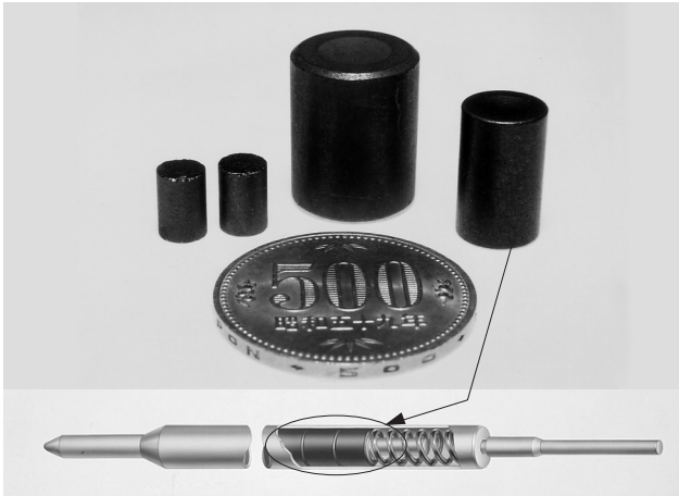
3-2 ペレット（上）と燃料棒 ペレットは左から「もんじゅ」 「ふげん」、軽水炉用のもの（上部写真：核燃料サイクル開発機構提供、下 部イラスト：東京電力提供）
