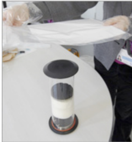
石英繊維フィルター(上)と活性炭素繊維フィルター(下の円筒中の黒い部分)
