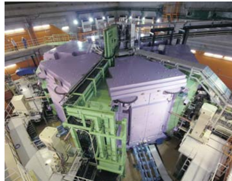
図4-8 RI ビームファクトリー(RIBF) 超伝導リングサイクロトロン
